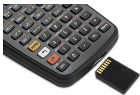
Alloggiamento per schede SD per espansioni di memoria e trasferimento dati 1
